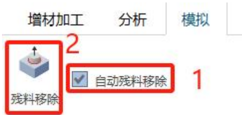
图 32:残料移除模拟选项：[1]自动残料移除，[2]残料移除
