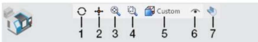
图 8:抬头视图工具栏，机床视图。[1]旋转，[2]平移，[3]最佳视图，[4]缩放，[5]视图(带有当前视图的名称)，[6]屏蔽，[7]剖视图。
