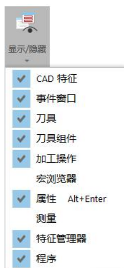
图 12: 使用初始设置选项卡上的“显示/隐藏”窗格命令来控制工作窗格的显示。
